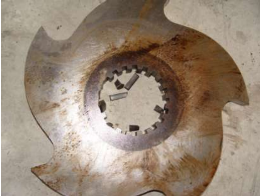
Рис. 2. Разрушение шлицев фрезы
