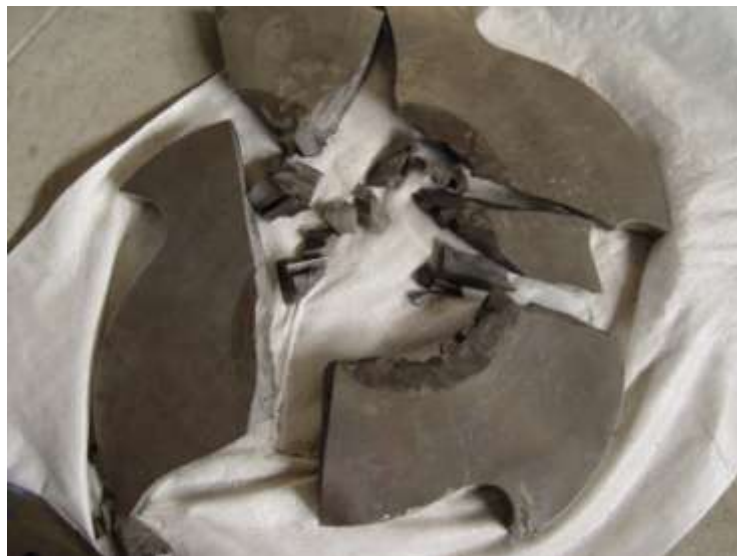
Рис. 1. Характерное разрушение фрез
