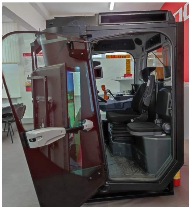
Рисунок 1 Тренажер «Кабина зерноуборочного комбайна Акрос»
